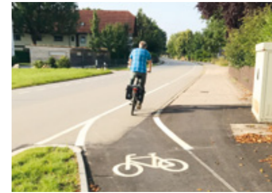
Im Ort wird der Radweg als Fahrradschutzstreifen geführt. Das verengt optisch die Fahrbahn und bremst die Autofahrer ab.
